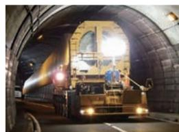
依托起立装置搬运螺旋桨（螺旋桨放倒时）
